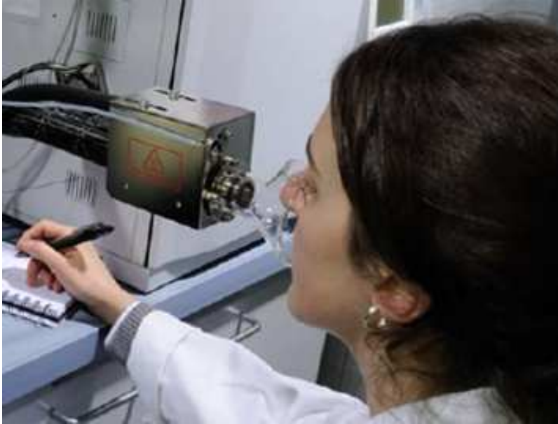
Expérience de GC-O en cours. L'opératrice décrit l'odeur des composés isolés du mélange et transportés vers le cône d'olfaction
