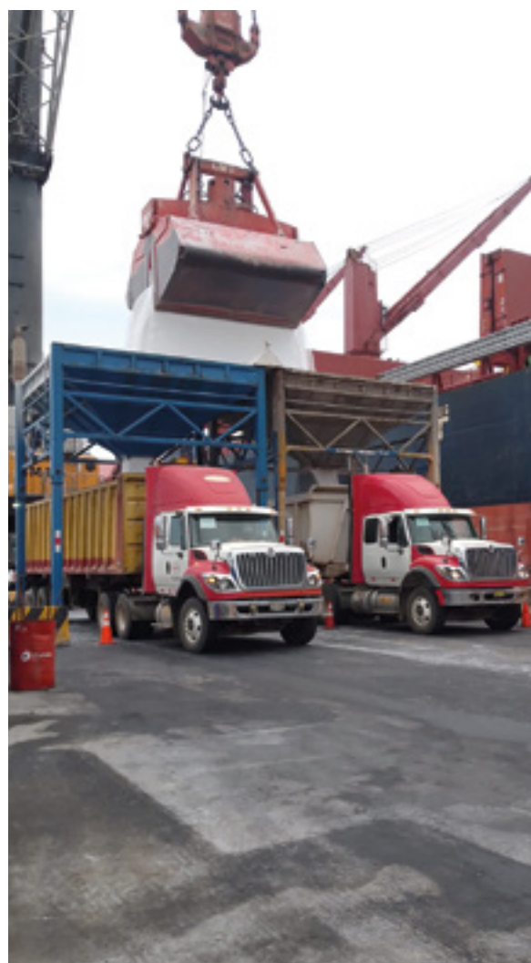
Figura 26 – Sistema implementado de dos tolvas pequeñas juntas en paralelo unidas 28
