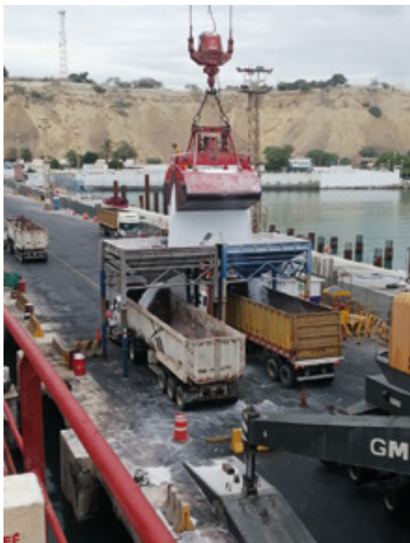
Figura 27 – Sistema implementado de dos tolvas pequeñas juntas en paralelo unidas 29
