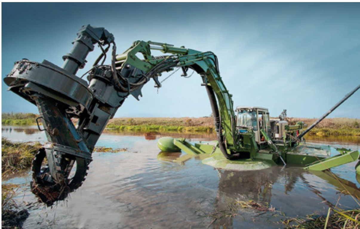
Figura 18 – Ejemplo de Draga Anfibia Polivalente 20
