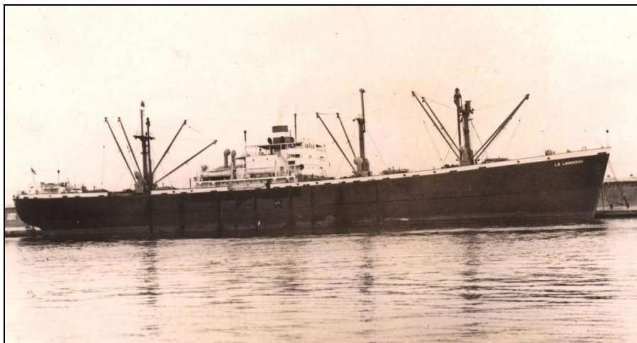
figure II-9 : Le KETTARA VIII, de l'armement Compagnie Minière et Métallurgique, en flotte de 1963 à 1964, dernier navire à vapeur à entrer en flotte au Maroc ; construit en 1943 ; Jauge brute de 7 176 tonneaux ; 135 m de longueur ; c'est un « Liberty ship ». Le terme Liberty ship désigne les 2 710 cargos fabriqués aux États-Unis au cours de la Grande Guerre (1939-1945), ce qui en fait le modèle de bateau le plus produit au monde, (photo : Yvon Perchoc).
