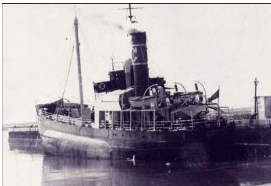
figure II-8 : Le navire citerne MARNA, de l'armement Compañía Marroquí de Navegación, en flotte de 1950 à 1959, inscrit à Rio Martin (Martil) ; sa coque munie de gros caissons stabilisateurs qui l'empêchent d'approcher le quai à moins d'un mètre ; construit en 1911 ; (photo : José Perez Del Rio).
