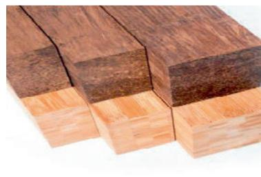
**Photo 8:** Poutre en lamellé-collé de bambou
